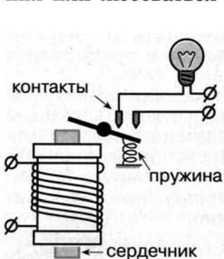
Рис. 2.14 Схема электромагнитного реле
